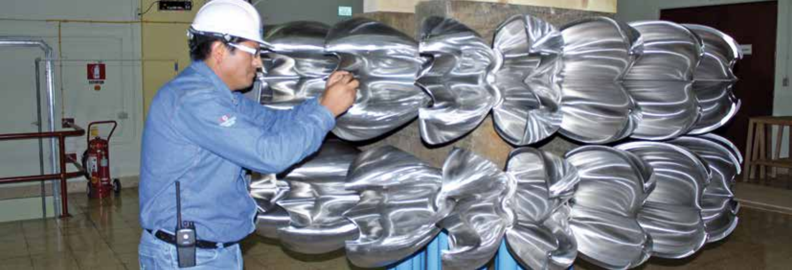
Inspección Rodete Pélton C.H. San Gabán II / San Gaban II Hydroelectric Station impeller check
